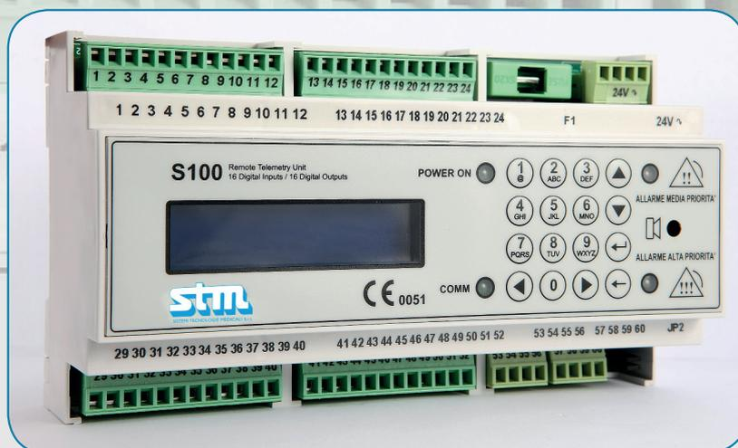
Dispone di 16 ingressi optoisolati e 16 uscite optoisolate che possono essere programmati dall'installatore dell'impianto tramite una tastiera frontale comoda e intuitiva. Per ciascuno degli ingressi è possibile associare una dicitura della condizione di allarme che verrà visualizzata all'occorrenza.
